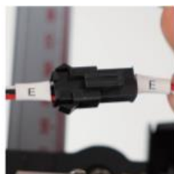
E (3PIN) → Signální kabel detektoru plamene
