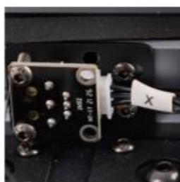
X (3PIN) → Kabel koncového spínače osy X
