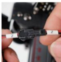
Z (2PIN) → Kabel koncového spínače osy Z
