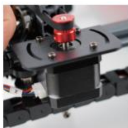
X (4PIN) → Kabel krokového motoru v ose X
