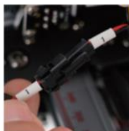
1 (2PIN) → Linka laserového ventilátoru
