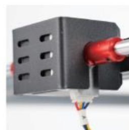
Y (4PIN) → Kabel krokového motoru pro osu Y
